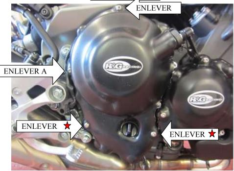
Le kit doit contenir : 1 x Protection carter moteur (ECC0163) 4x M6 x 40mm Boulons 2x M6 Rondelles 1x 'P' Agrafe
