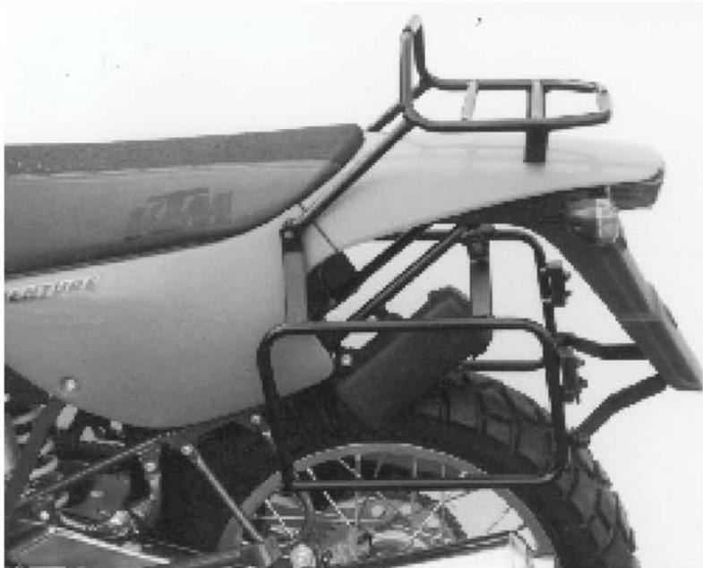
Die Befestigung des Versteifungsbügels erfolgt an den hinteren seitlichen Laschen der Kofferträger mit den Sechskantschrauben M 8 x 25 nebst U-Scheiben und selbstsichernden Muttern. Er verläuft im Kotflügel und wird mit diesem nicht verschraubt.
