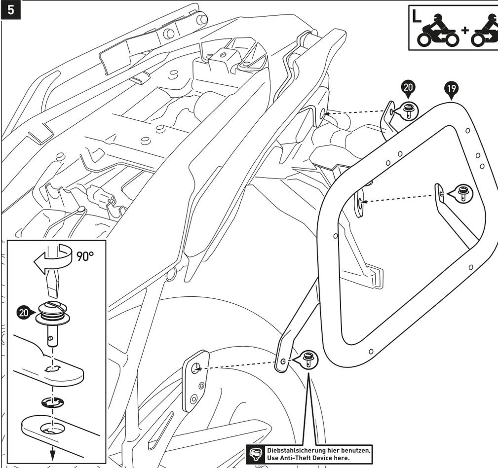
Verbinden Sie die Kofferträger (19) und mit den Schnellverschlüssen (20) an den Befestigungslaschen und dem Querverbinder. Sichern Sie die Schnellverschlüsse mit den Sicherungsscheiben.
