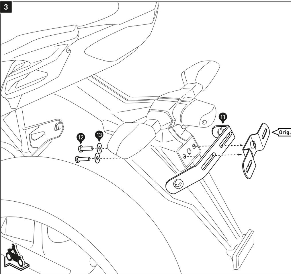
Entfernen Sie das originale Kennzeichenhalteblech (Orig.) vom Kotflügel; verschrauben Sie den Querverbinder (11) mit dem Kennzeichenhalteblech (Orig.) am Kotflügel, wie in der Zeichnung gezeigt.
