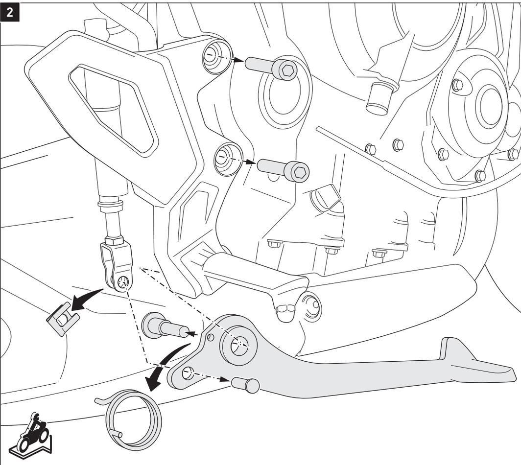
Lösen Sie die Schrauben der Fußrastenhalterung um mehr Freiraum für die Montage zu haben.
