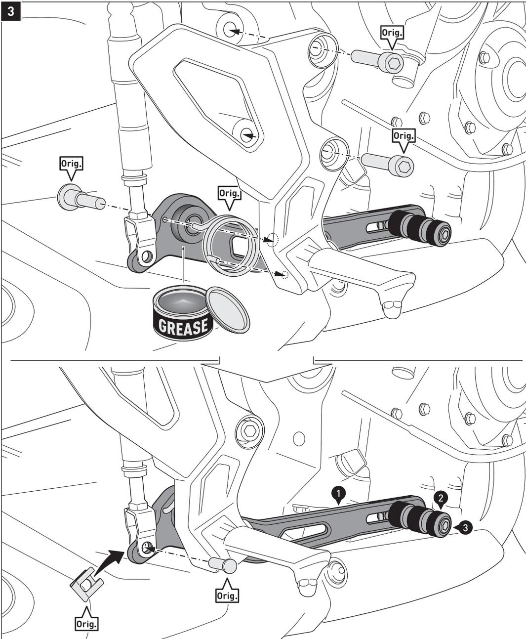
Verschrauben Sie den Bremshebel (1) mit den original Teilen (Orig.) am Fußrastenhalter.
