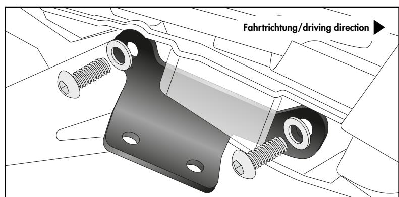
Im Bereich der Adapter müssen die demontierten Verkleidungsteile ca. 5mm hoch mit geeigneten Werkzeug (z.B. Dremel) ausgespart werden. Die ausgesparten Verkleidungsteile wieder montieren.
