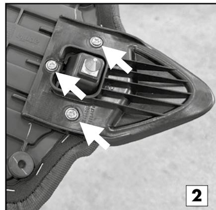
Fahrersitzklemmung an der Gepäckplatte montieren.
