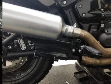
Fig. 1.7 remove upper muffler.
