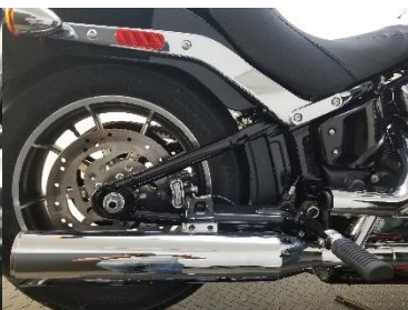
Fig. 3.4 remove upper muffler
