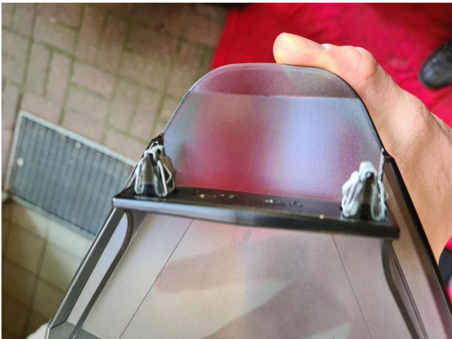
Schritt 2: Das kleine mittlere Windschild durch „Ziehen nach oben“ ausclippen.
