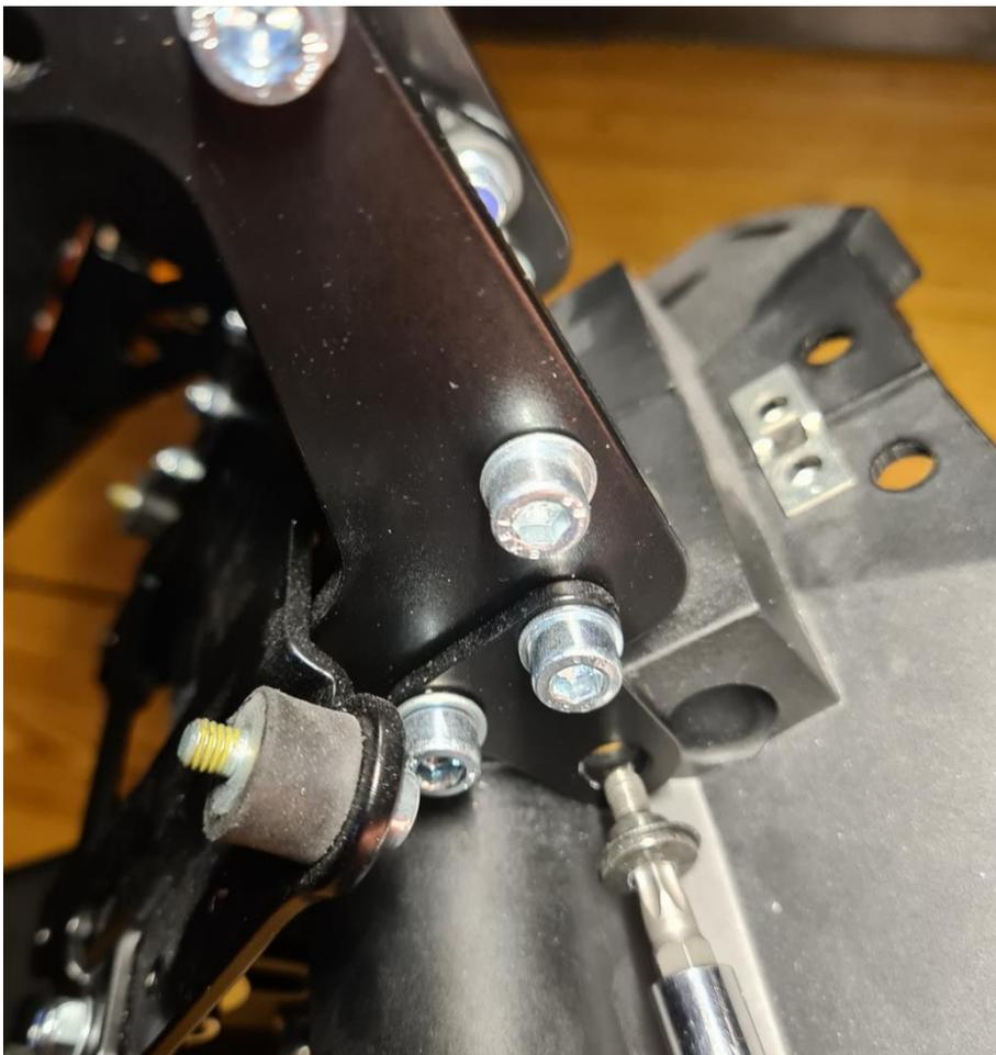
Schritt 18: Anhand der beiden originalen M5 Torx Schrauben wird der obere Teil des NAVPOD 21 beidseitig an das Cockpitgehäuse geschraubt.
