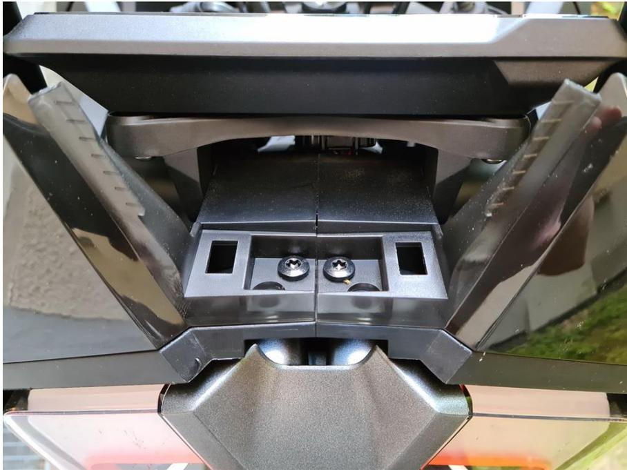
Schritt 3: Durch Lösen der beiden freigelegten Torx-Schrauben kann man die linke und rechte untere Windschildhälften entfernen.
