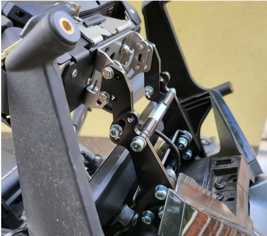
Schritt 21: Bevor man alle Windschilder wieder montiert, empfiehlt es sich das Navigationsgerät zu montieren und dann zu positionieren.
