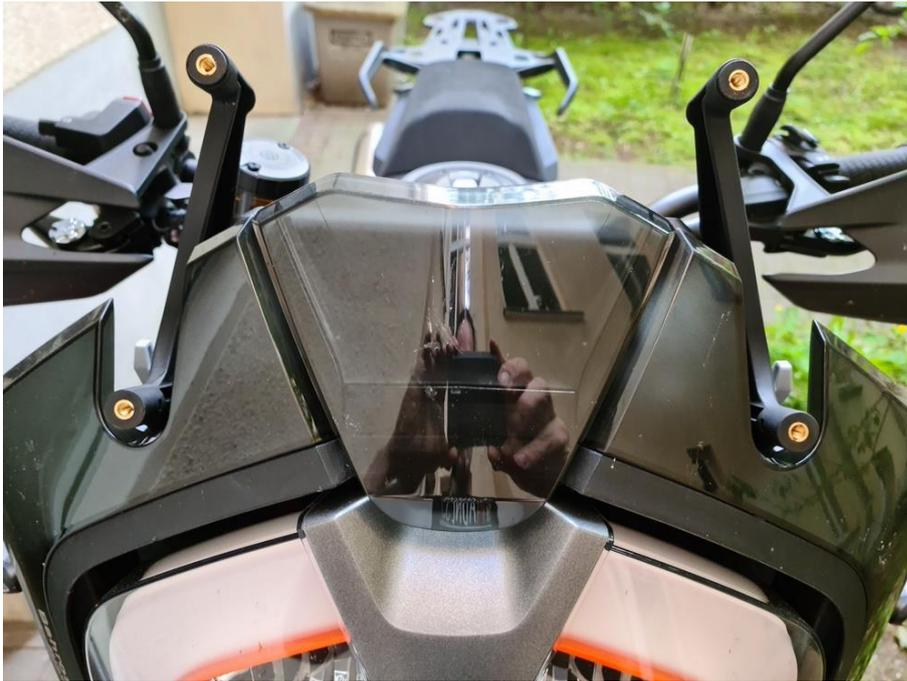
Schritt 1: Zum Entfernen des oberen Windschields die vier M5 Torx-Schrauben lösen.
