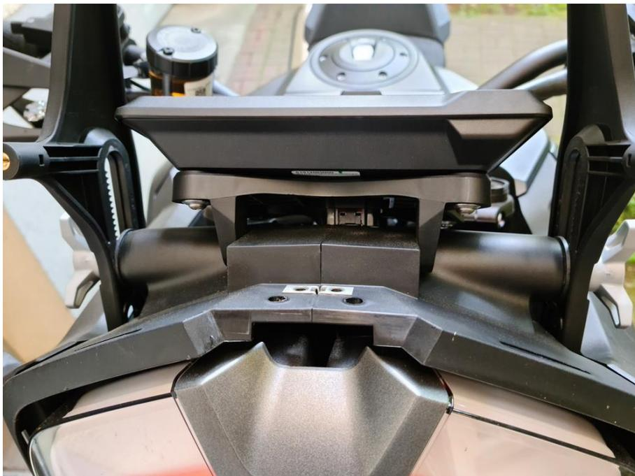
Schritt 4: Durch Lösen der vier unteren Linsenkopfschrauben, kann man das TFT Tacho abnehmen. Die Gummidämpfer verbleiben am TFT Tacho.
