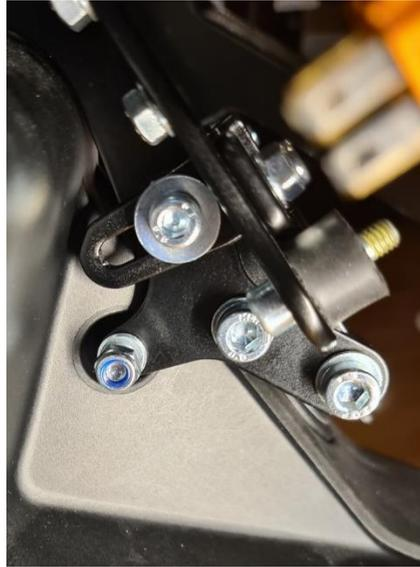
Schritt 17: Die durchgesteckte 110mm M5 Schraube mit Unterlegscheibe und M5 Mutter sichern. Das Ergebnis sollte dann wie auf den Bildern aussehen.
