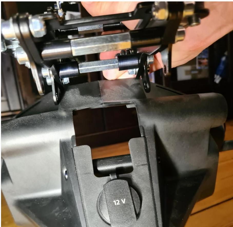
Schritt 14: Der NAVPOD 21 wird jetzt oben vorsichtig aufgesetzt. Gegebenenfalls bietet es sich an die vorderen Buchsen festzuhalten. Der Tachostecker sollte zudem durch die Aussparung geführt sein.
