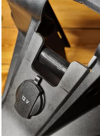
Schritt 9: Der schwarze Abstandshalter kommt an die Position des ursprünglichen Winkelverstellers. Richtig herum so wie der NAVPOD 21 kommt. Die Abstände sind etwas unterschiedlich links und rechts.
