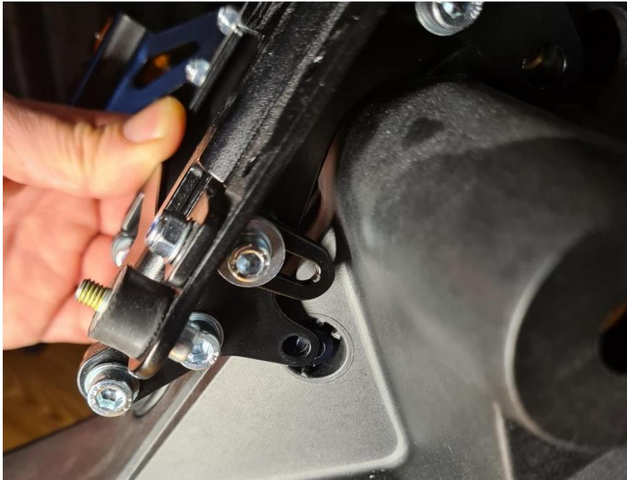
Schritt 15: Der vordere Bereich wird nun über die Buchsen geführt.
