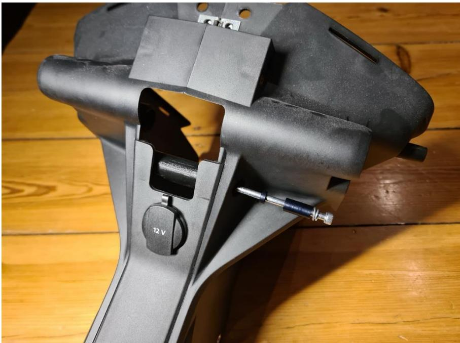
Schritt 10: Zur Vorbereitung für die eigentliche Montage des vorderen Bereiches, nimmt man die 110mm M5 Schraube und steckt die 20mm Buchse (nach außen) und 4mm Buchse (nach innen) darauf und führt diese dann durch die vordere Aufnahme.
