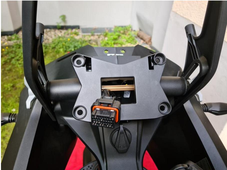
Schritt 5: Jetzt zieht man den Stecker vom TFT-Tacho durch drücken des kleinen Hebels.
