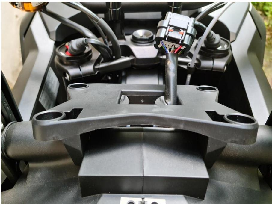
Schritt 6: Entferne die beiden seitlichen Torx-Schrauben oben am Tachohalter. In Fahrtrichtung gesehen wird links unten am Tachohalter noch eine versenkte Torx-Schraube entfernt. Dann wird die Edelstahlachse der Tachowinkeleinstellung nach rechts (mit etwas Nachdruck) herausgeschoben. Danach kann der Tachohalter abgenommen werden.
