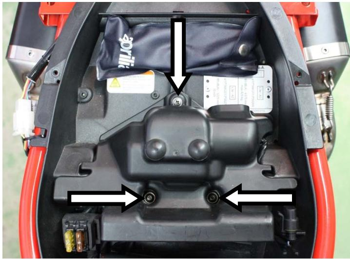
**IT** · Rimontare la copertura del vano sottosella
