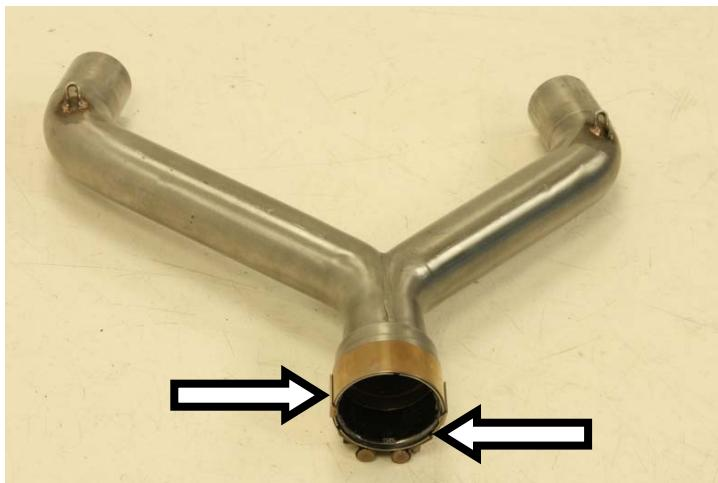
**IT** · Alloggiare guarnizione e fascetta di serraggio originali nell'imbocco del raggruppamento
