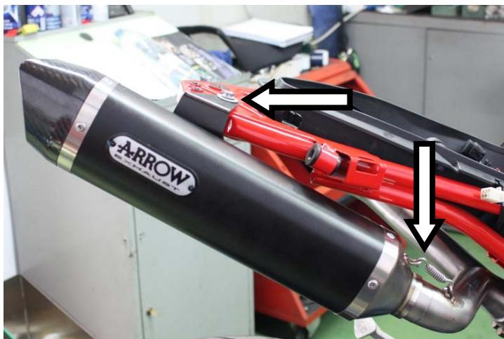
**IT** · Innestare i terminali, serrare senza stringere completamente gli attacchi al telaio ed ancorare le molle
