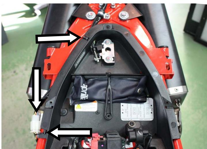
IT · Riconnettere il cablaggio, fissare il cavo mendiate fascette e rimontare cavo e guaina di apertura sella
